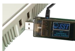
Equipamento base a ligar ao router internet via wireless.
